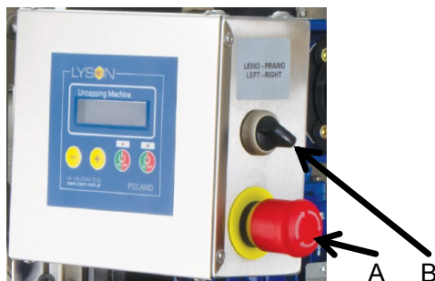
Fig.19. Emergency switch „STOP” A
