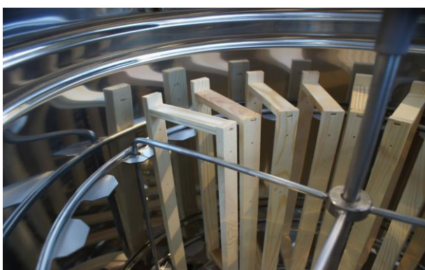
Rys. 7 Prawidłowe ułożenie ramki w koszu radialnym
