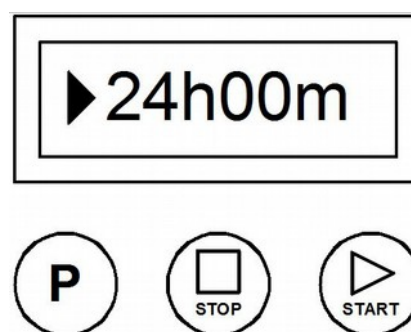
Рис. 2. В зависимости от предыдущих настроек экран показывает ранее заданное время работы кремовалки.
