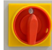
Fig. 19. Main switch „0” position
