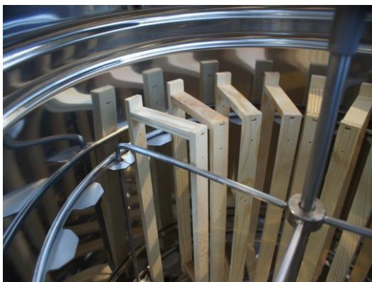
fot.1 Prawidłowe ułożenie ramek w miodarce radialnej
