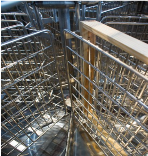
fot.1 Prawidłowe ułożenie ramek w miodarce kasetowej
