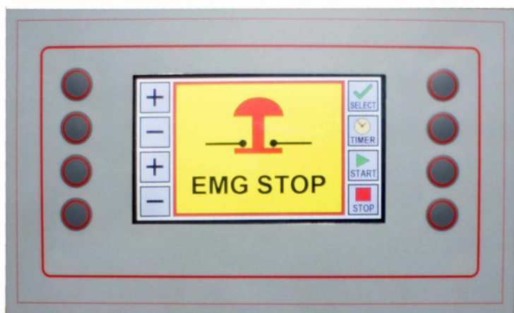
Fot.9 Wciśnięty jeden z dwóch przycisków „STOP AWARYJNY”
